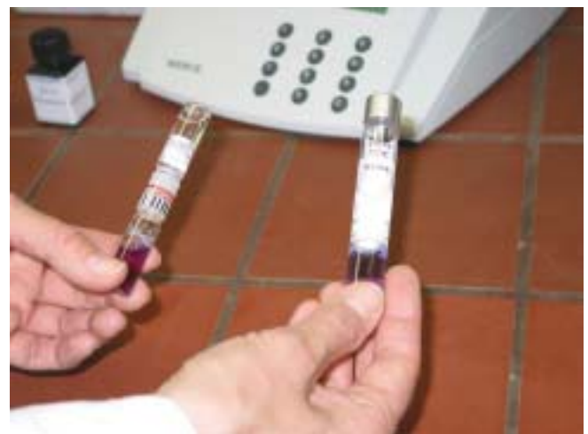
Abb. 2: TOC-Küvettensysteme. Links: zusammenschraubte Küvetten (Dr. Lange), rechts: Küvette mit integrierter Membran und Alukappe (Merck)
